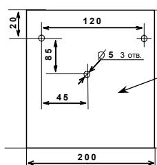
2.2.1 РИП устанавливается на стенах или других конструкциях охраняемого помещения в местах, защищенных от воздействия атмосферных осадков, механических повреждений и доступа посторонних лиц.
