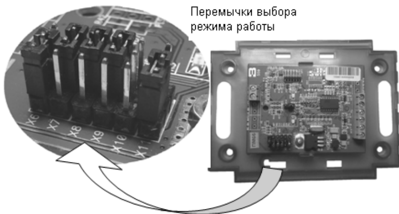
Рисунок 6 – Расположение перемычек на плате адаптера
